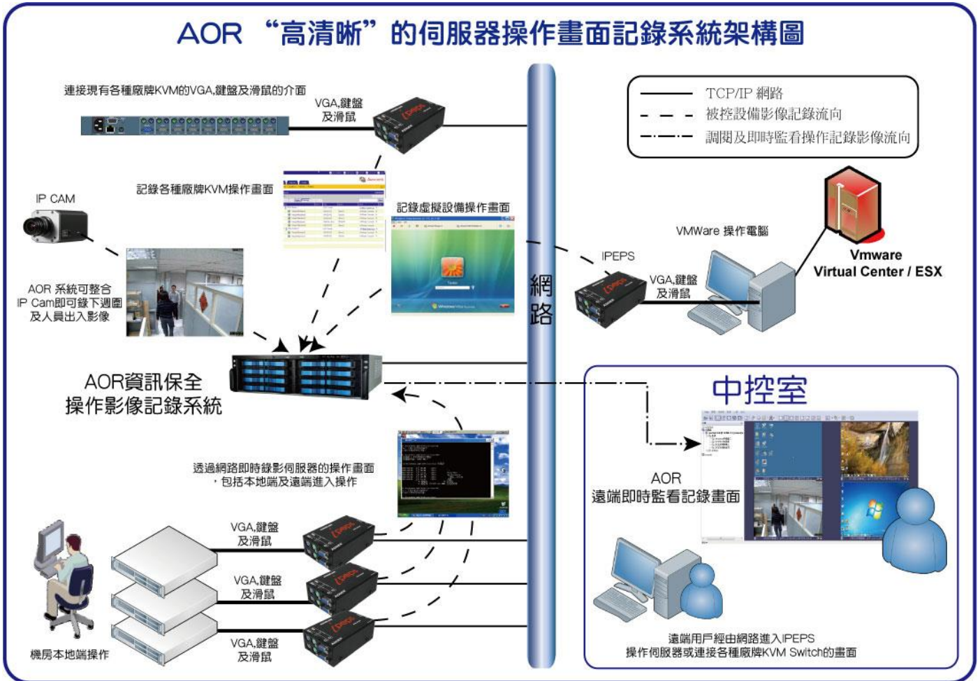
圖 2：AOR 資訊操作記錄系統 - 影像擷取模組、攝影機架構圖（一）
